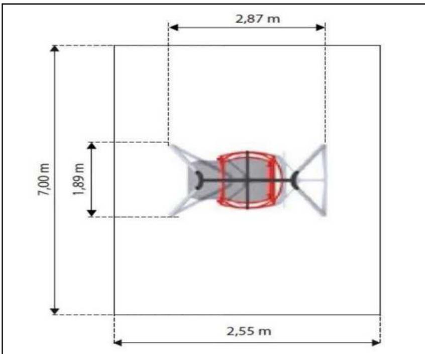
Columpio en góndola para un usuario de silla de ruedas. El columpio está equipado con un Sistema de Seguridad INTEGRADO de cinco etapas.
